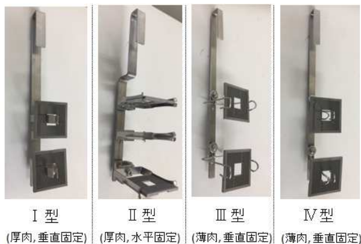
図45. 試作した4種の治具の外観
