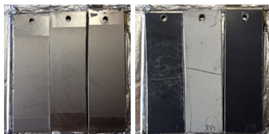
図15. めっき後の外観 UV照射(左)と未照射(右)
