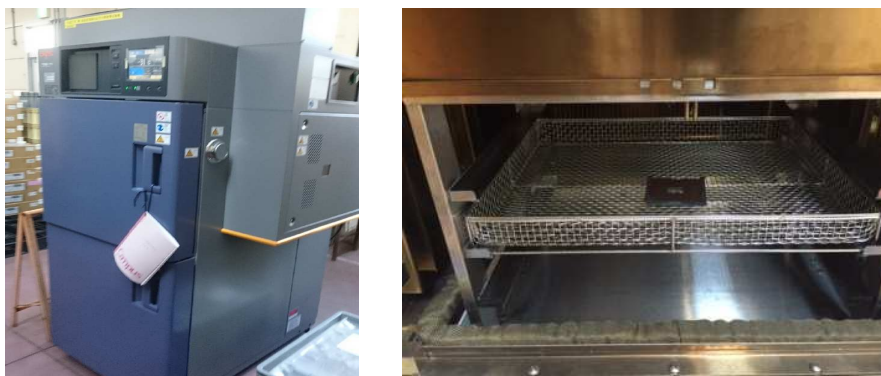
図40. 冷熱衝撃試験機（左）と試験中の様子（右）
