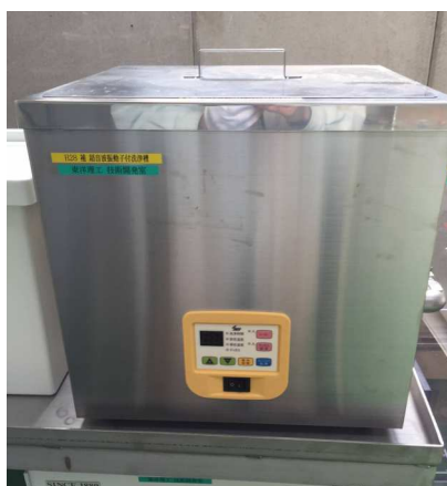
図5 2. 超音波振動子付洗浄槽
