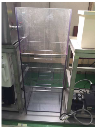
図51. 縦積層型水洗槽
