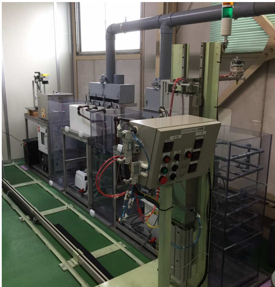
図7. 本事業で導入しためっき試作用テストラインの外観
