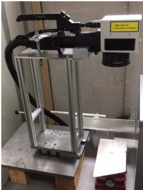
図19. レーザークリーナー外観
