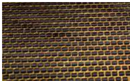
図29．実験9で生じた微小孔内部のめっき未着の様子 金めっきが析出せず、黒い素地が露出している
