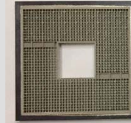
複雑形状物選択部分めっき品外観（左）と微小孔部の様子（右）
