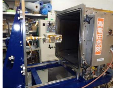
図 13 スパッタ装置 完成写真 (H28 年次) 図 14 スパッタ装置 (基盤取り付け機構)
