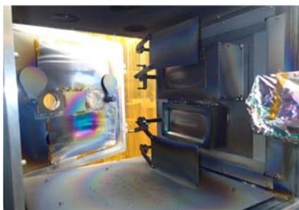
図4 チャンバー内部 Ti カソード
