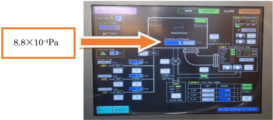
図3 スパッタ装置タッチパネル
