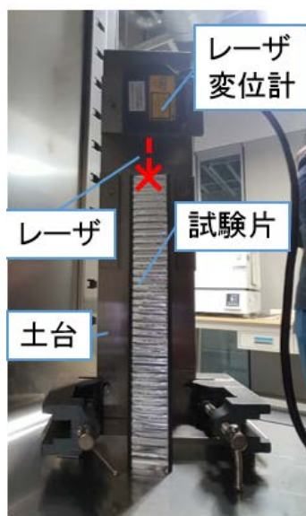
図 25 熱変位の評価実験状況
