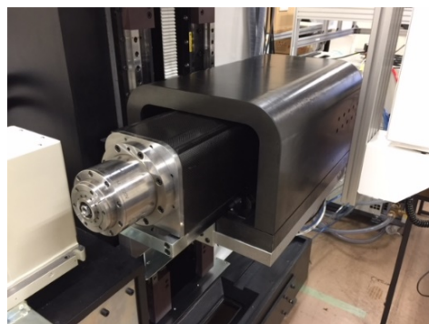
図 20 主軸スピンドルとクイルの接着/ねじ締結の状態
