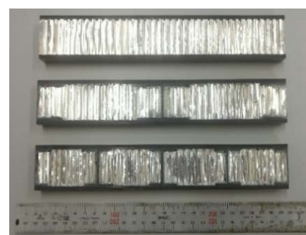
図5 3種のCFRP-アルミハニカム構造体
