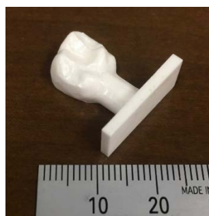
図29 開発工法で製作した本焼成ジルコニア製歯冠補綴物
