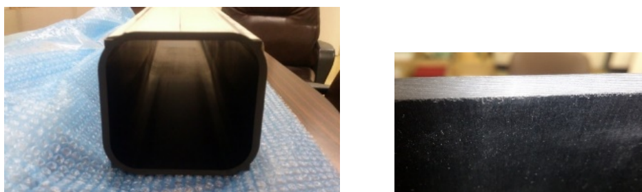
図9 CFRP 成形品の端面切断の例
