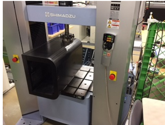
図 15 機械的強度の評価（Y 軸 Box 構造体）
