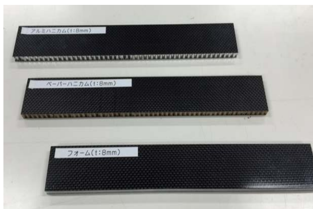
図11 3種類のCFRP複合構造材
