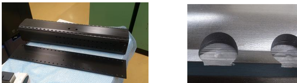
図8 CFRP 曲面成形部へのねじ締結用穴加工の例
