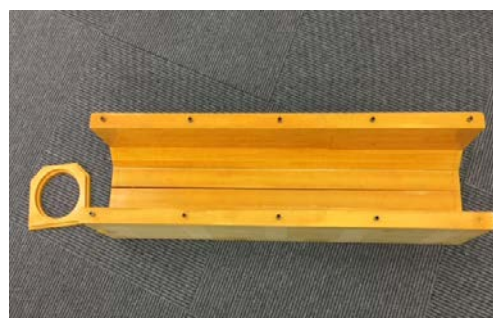
図 3 CFRP 成形金型（左：パールボード製）
