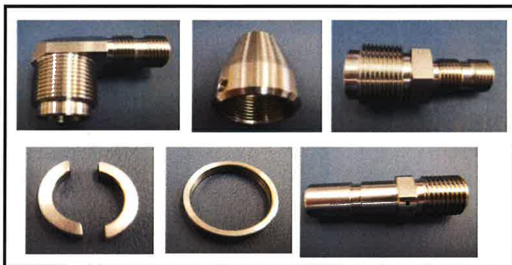
図7：チタン合金製試作部品（抜粋）
