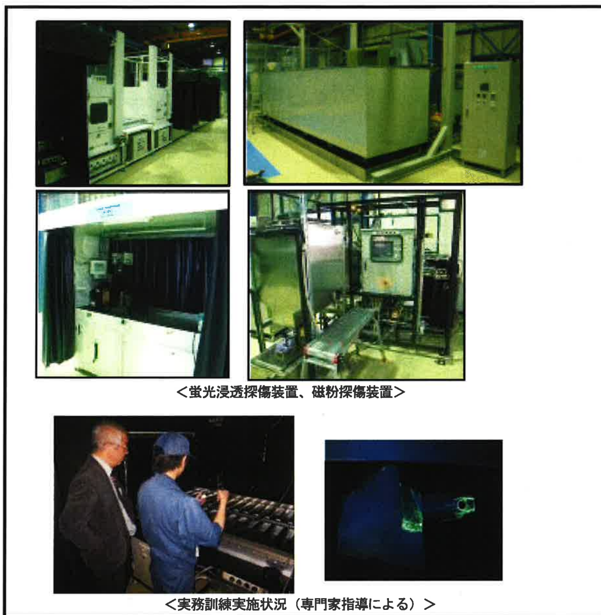
図 9：非破壊検査設備設置状況及び実務訓練実施状況
