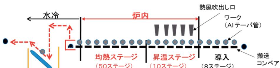
図 2-1-5 溶体化炉の構造概念図
