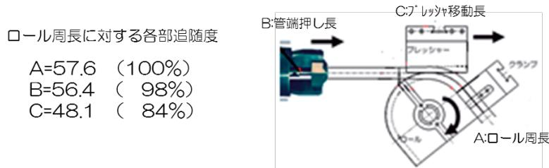
図 2-2-3 プレッシャー型の移動量調査
