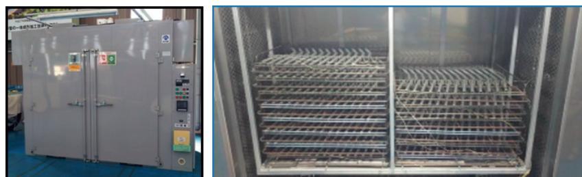
図 2-1-13 時効炉外観と炉内の様子（時効台車）
