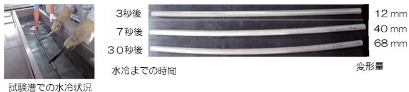
図 2-1-9 水冷試験とアルミ管の変形量
