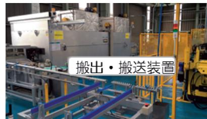
図 2-1-12 溶体化炉とベンダーをつなぐ搬出・搬送装置
