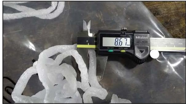
PE材のMFR違いにおいては温度設定が一定であるため一概には言えないが、高流動PEの方が発泡倍率は高い。連続性においても高流動PEの方が良いように見えた。（粘性により暴破がぼやけている可能性がある）
