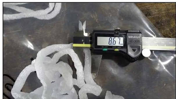
PE材のMFR違いにおいては温度設定が一定であるため一概には言えないが、高流動PEの方が発泡倍率は高い。連続性においても高流動PEの方が良いように見えた。（粘性により暴破がぼやけている可能性がある）
