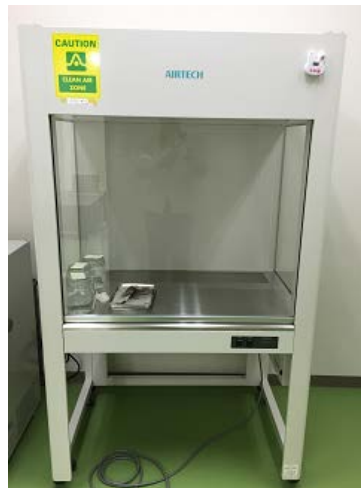
図 B クリーンベンチ
