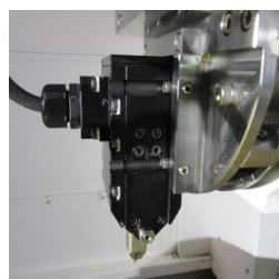
(楕円振動装置を用いた 3 軸加工)
