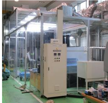
平面研削実験用温調チャンバー
