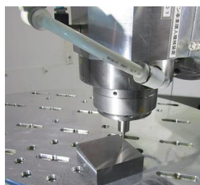
10 万回転主軸による切削実験
