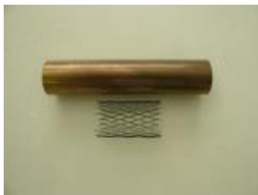
図3-2-4 熱処理により拡張したステント
