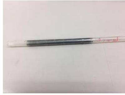
開発したステント縮径方法によりチューブ内への縮径に成功
