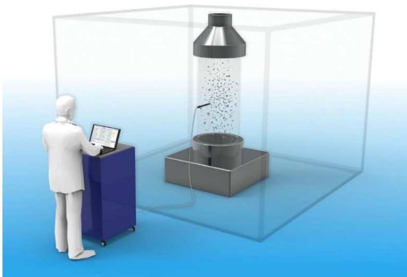
図 1.3 小型可搬可視化プローブを挿入して濃密浮遊粒子群の測定を行っているイメージ図
