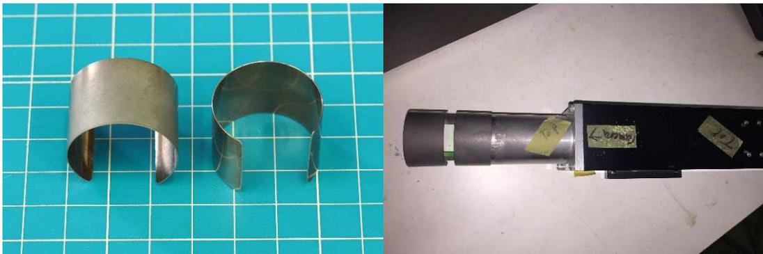
図 2.33 (左) 金属カバー、(右) 金属カバーをプローブに装着した様子
