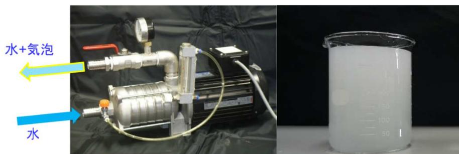
図2.7 マイクロバブル発生装置と発生したマイクロバブル
