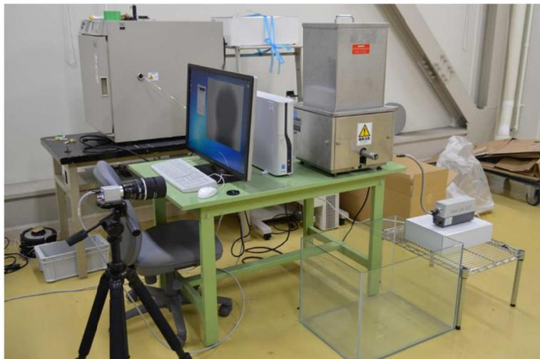
図2.13 粉体連続落下装置と固体粒子撮影システムを設置した様子
