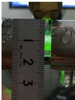
図 2.21 噴霧ノズルと計測プローブ先端部の位置関係（図は 0mm の設定。）
