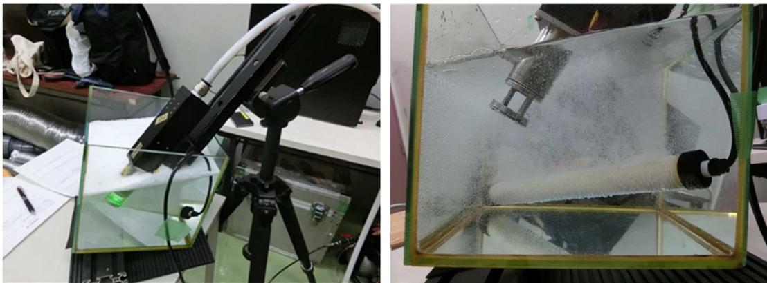
図 2.17 可視化プローブを用いたマイクロバブルの計測の様子
