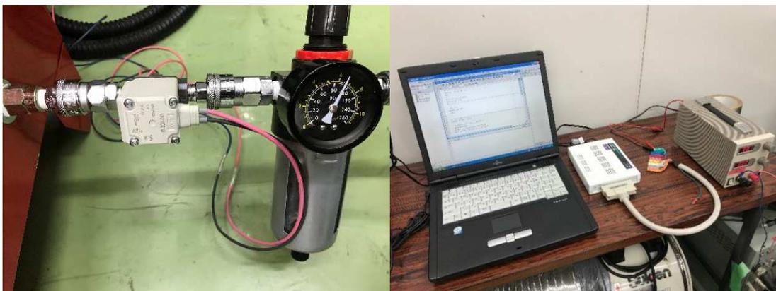
図2.36 (左) 電磁バルブ、(右) 電磁バルブのオンオフ制御装置
