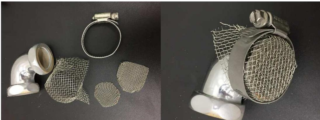
図2.35 粒子速度を低減させるためのエルボと金網
