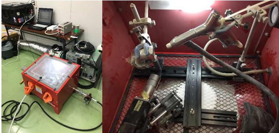
図2.34 (左) サンドブラスタキャビネット、(右) キャビネット内部の可視化プローブ
