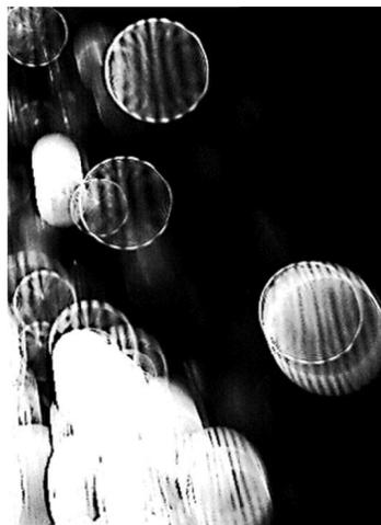
図2.12 干渉画像法による噴霧液滴撮影の例
