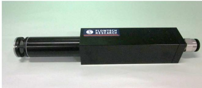
図 2.5 蛍光板を用いる非干渉性パルス背景照明技術と上述したクリーニング技術を搭載した可視化プローブ第 1 号試作機の外観写真
