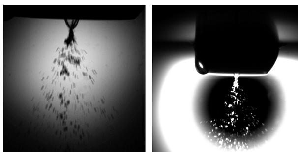
図2.44 （左）背景光照明を用いたシャドウイメージングによる噴霧液滴の撮影
