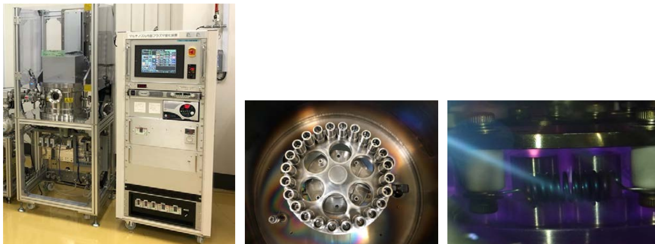
(a) マルチノズル内面プラズマ窒化装置 (b) マルチノズル窒化治具 (c) ホローカソードプラズマ発生
