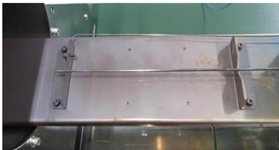
ステントを直径 2 mm の治具に装着し熱処理
