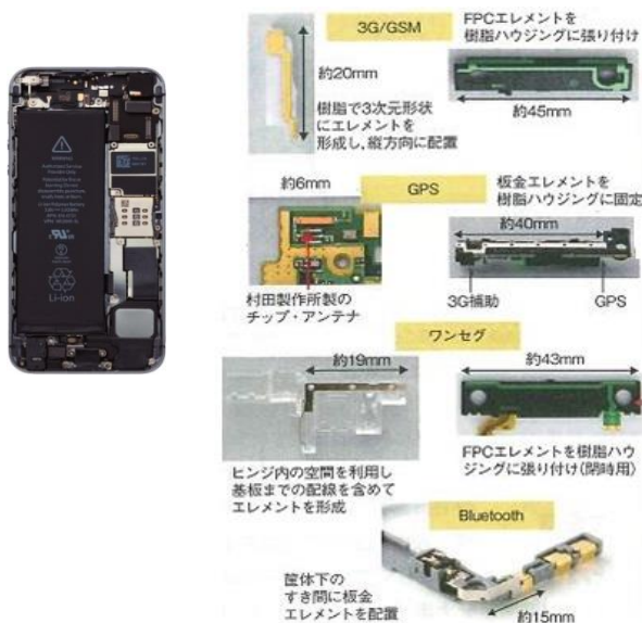
図3 無線信号用アンテナと細線同軸線
