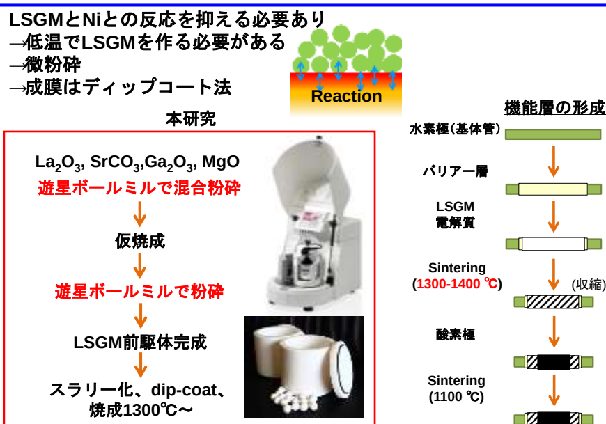
図 8 SORC の作製方法(電解質の合成方法および機能層の形成方法)
