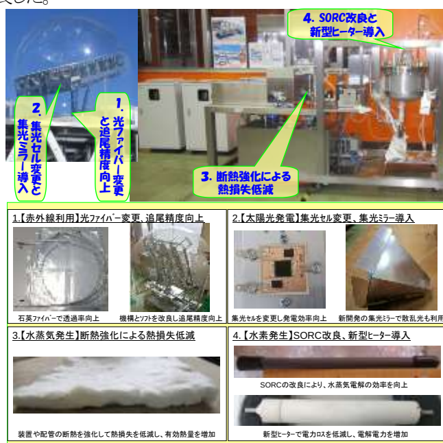
図 37 実証試験用ソーラー水素蓄電システムと主な改良点
