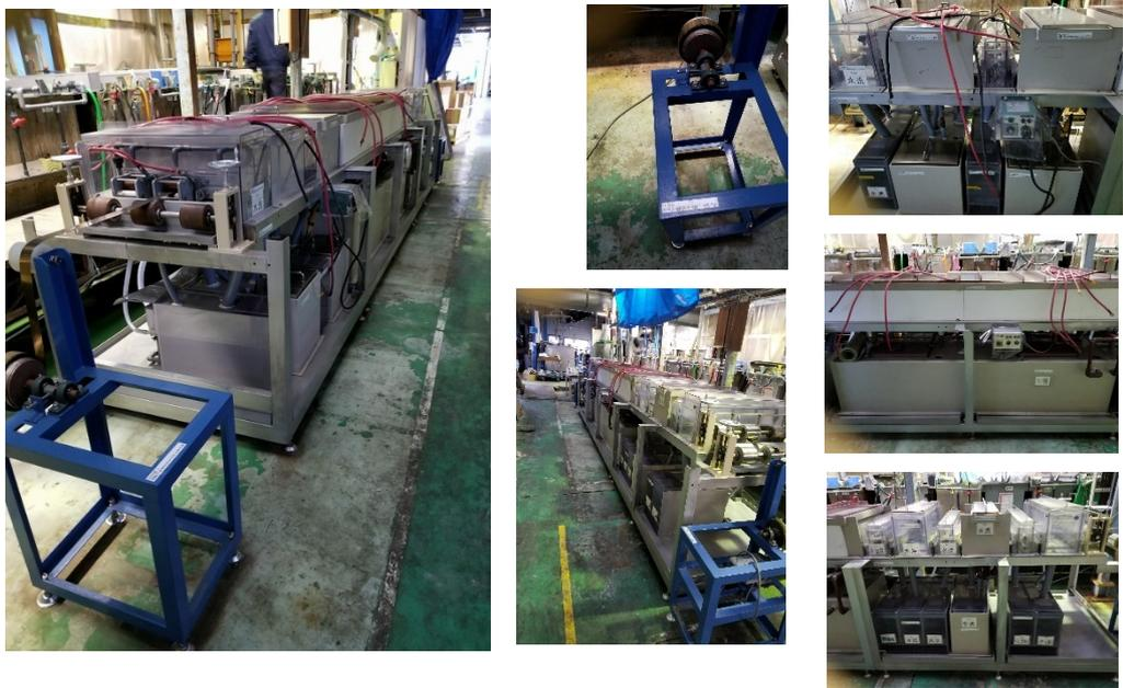
短冊形製品電気めっき試作装置（装置2）
