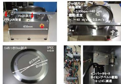
基礎的摩耗試験：ピン・オン・ディスク試験結果
