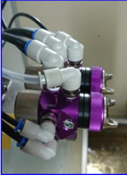
薄膜塗り重ねに特化し、抗菌塗装に最適のロボット用スプレーガンを開発し、ロボットに装着
