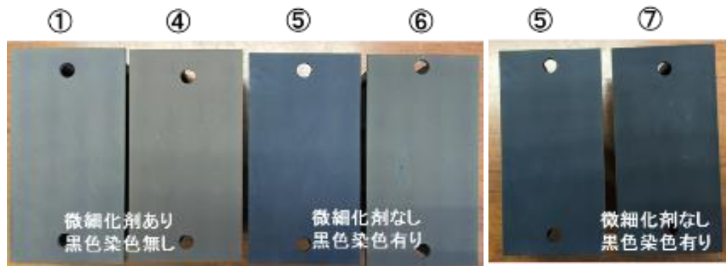
図 16 微細化剤, 黒色染色処理結果
