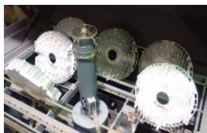
図6 塩水噴霧による耐食性試験
