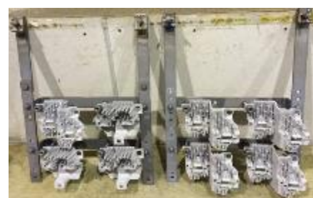
図 19 アルマイト処理用 チタン製治具4個掛け
