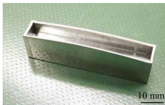
(b) 鍛造後の試験片形状
