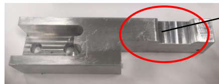
写真 232-2 クランプ部品改良後
