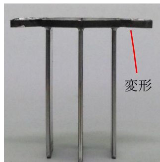
写真 222-6 ベース上面変形
