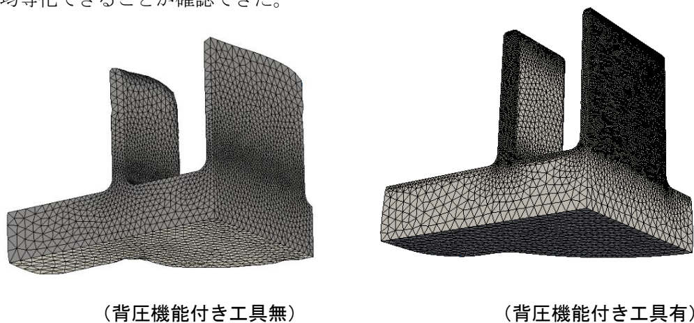
図 212-3 背圧機能付き工具有無による凸部成形形状の違い
