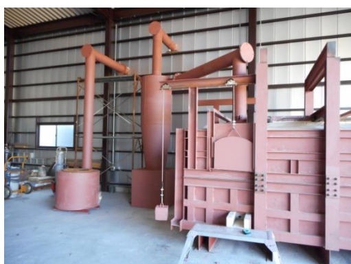
図6 炭素添加炉とガス抜き溶解炉
