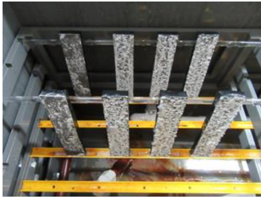
上段左より AC4C-C0.1%, AC2A-C0.4%, AC2A-C0.1%, ADC12-C0.4% 下段左より AC4C, AC2A, AC2A-C0.2%, ADC12
