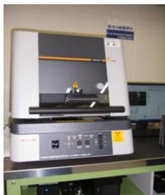
蛍光 X 線方式膜厚測定器
