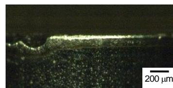
(d) コーティング膜： $\gamma$  切削距離：7.0m
