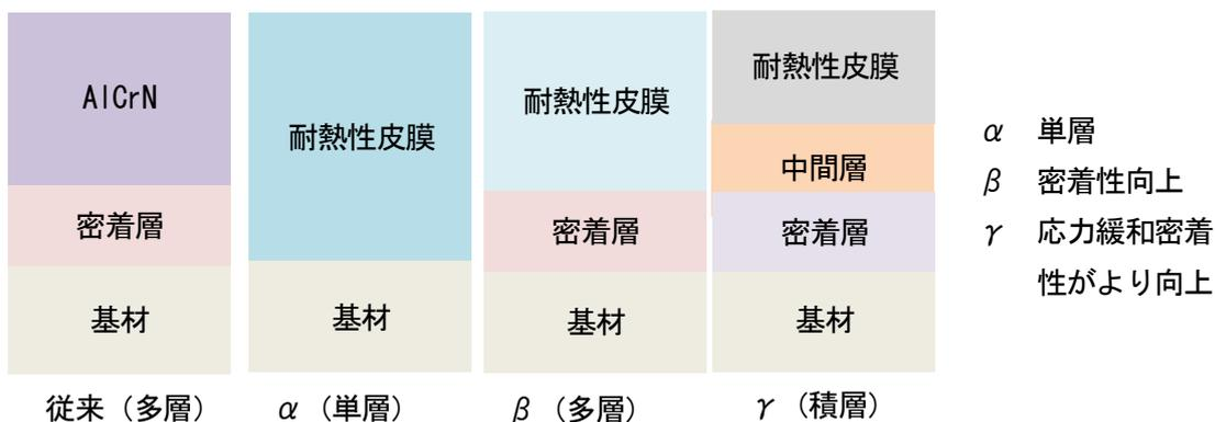
図 2-2-1 1 開発膜 α、β、γ および従来皮膜の構成概略図
