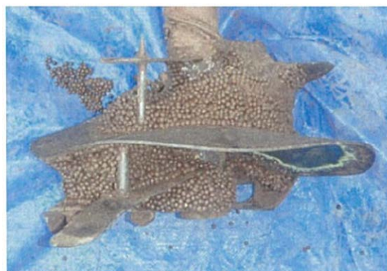
図6.攪拌羽に付着した炉内クリンカ
