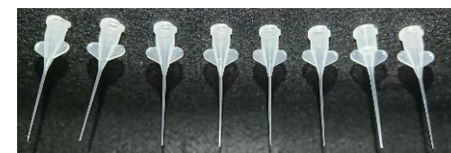
極細プラスチックニードル (先端外径0.25mm×先端内径0.1mm×軸長27mm)
