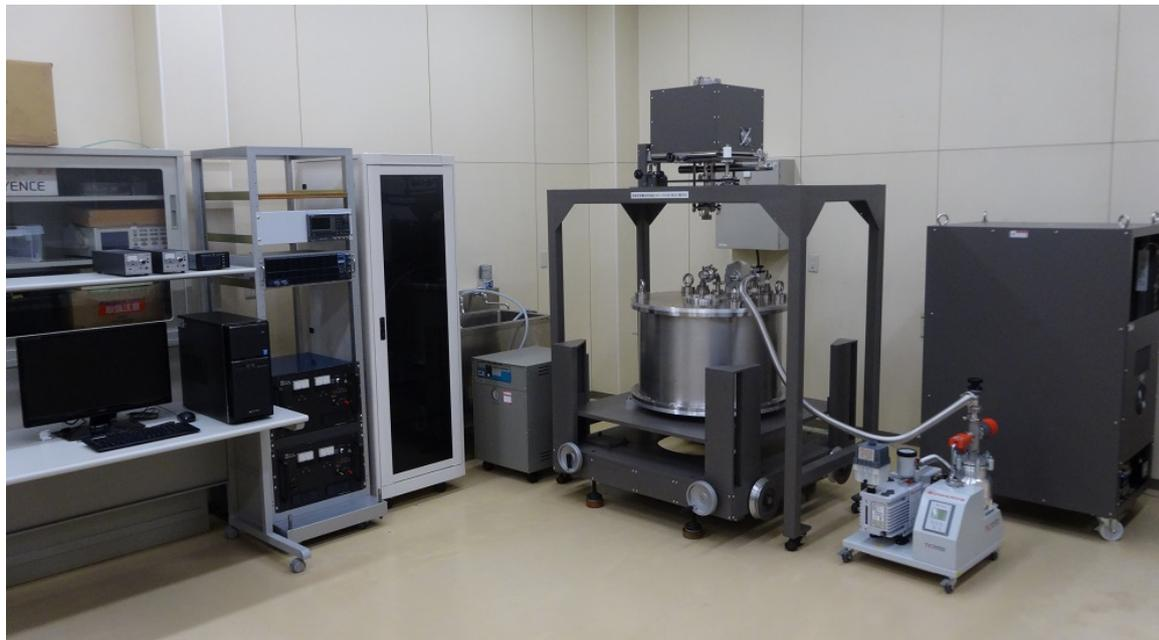
写真1 100kOe 無冷媒超電導ソレノイドコイル励磁方式磁気特性測定装置
