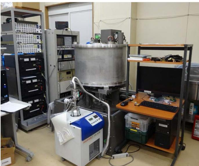
写真4 冷凍機振動打消し装置
