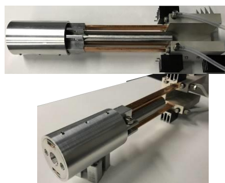
図 1.1.5 水冷式レーザ照射ヘッド（初期試作型）
