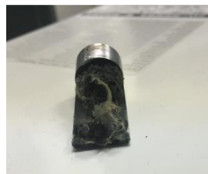
図 1.1.4 戻り光によるレーザ照射ヘッド内部の破損
