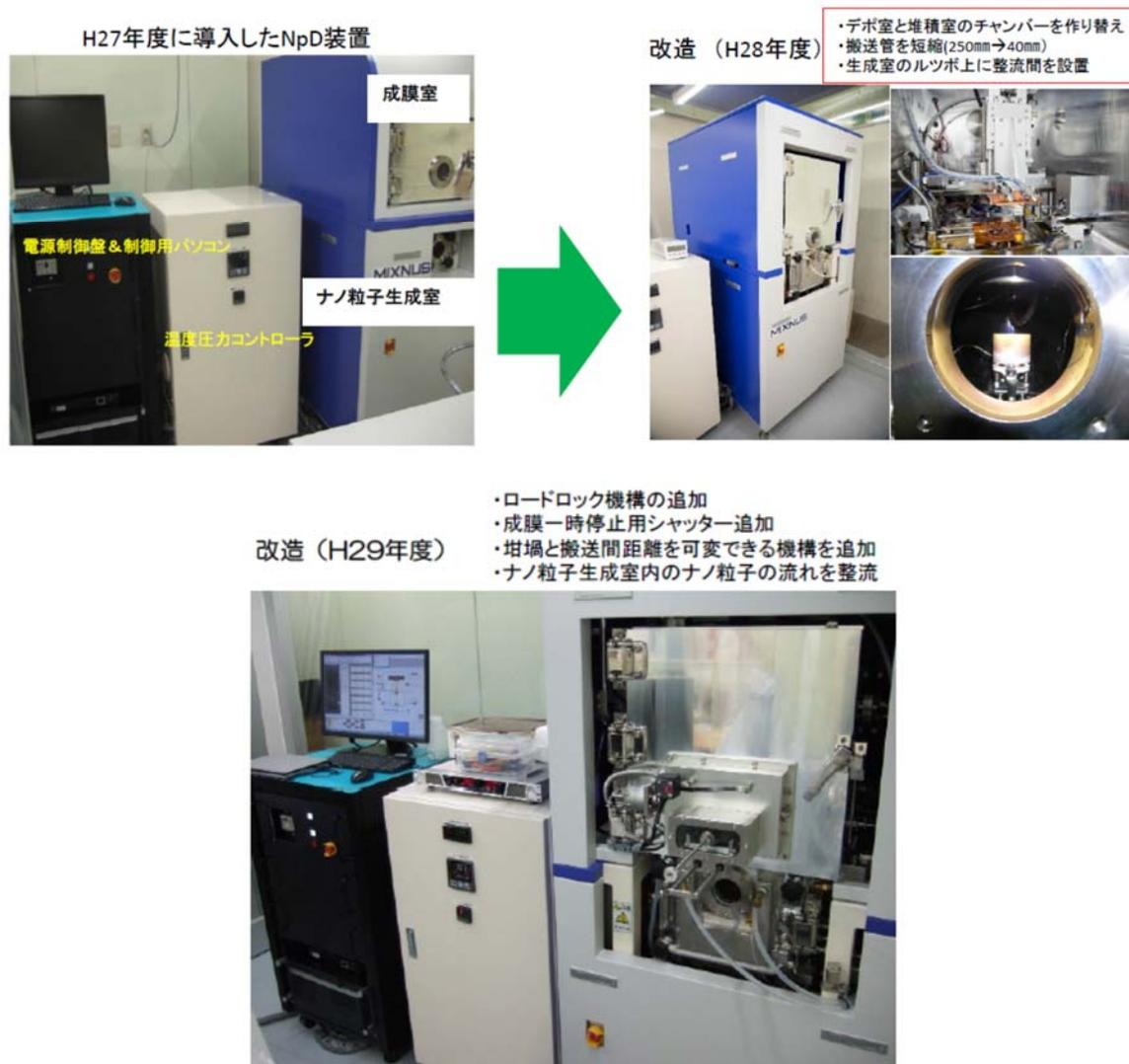
図 2.2 ナノパーティクル堆積装置
