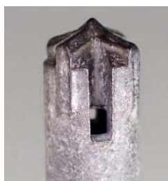
左写真：12m 穿孔試験 後の刃先外観
