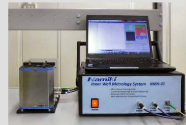
図(3) ハンディー型内周面精密測定機
