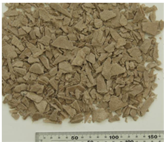
図7 25mm スクリーン使用時の破砕片
