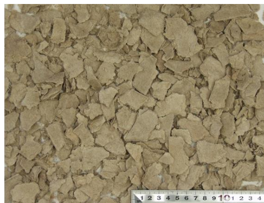
図13 45→35mm スクリーンで2段階破碎
