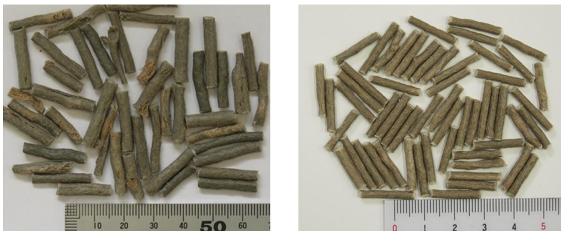
図61 1回混練押出によるペレットと2回混練押出によるペレット
