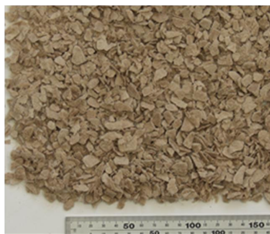
図8 15mm スクリーン使用時の破砕片
