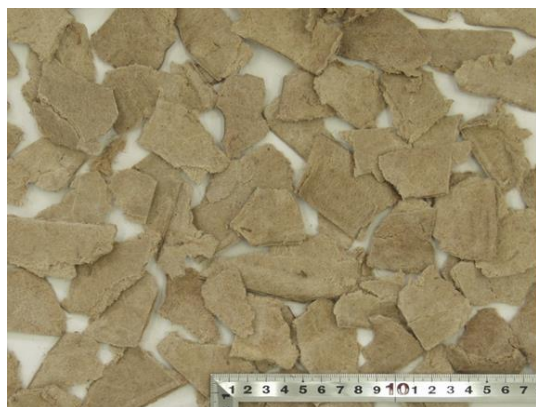
図12 50→40mm スクリーンで2段階破
