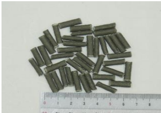
図28 ③ダイヘッド 12 穴(丸ダイ) 複合ペレットと繊維
