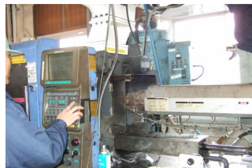
図44 射出成形トライ確認
