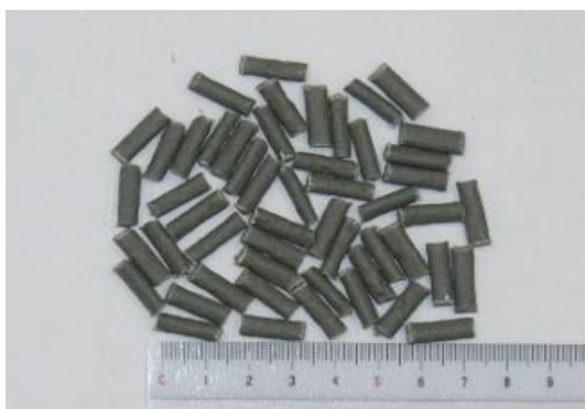
図27 ②ダイヘッド 11 穴(テーパー加工)複合ペレットと繊維
