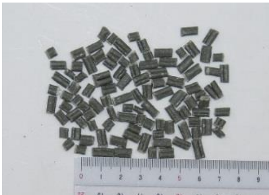
図26 ①ダイヘッド 21 穴 複合ペレットと繊維
