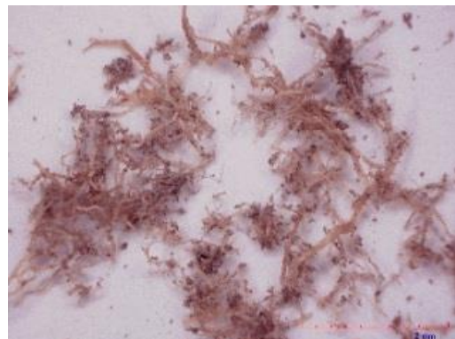
図26 ①ダイヘッド 21 穴 複合ペレットと繊維
