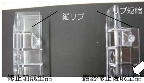
反応容器修正前後成型品写真
