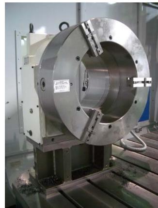
図 3-2-5 供試材取付具 (5)
