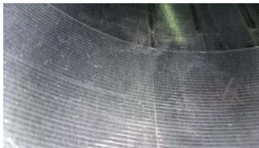
図 3-1-7 2 軸リバース方式特有の加工面
