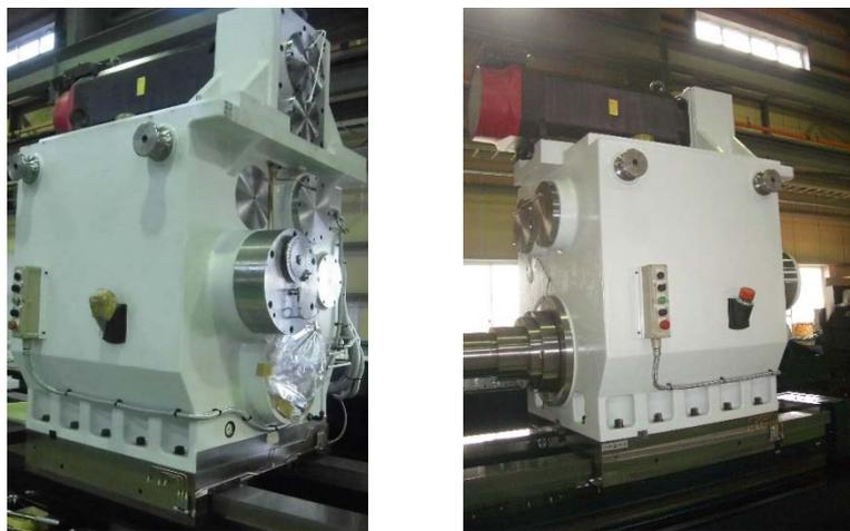
図 3-1-2 工具回転用ヘッド (改造部分)
