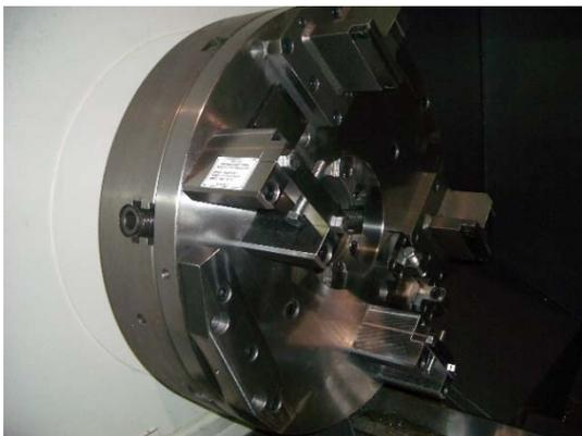
図 3-3-1 供試材取付具(8)
