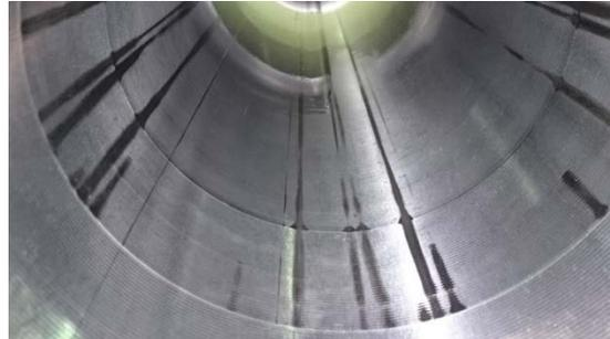
図 3-1-6 回転方式の BTA 工具のガイド部の擦り跡
