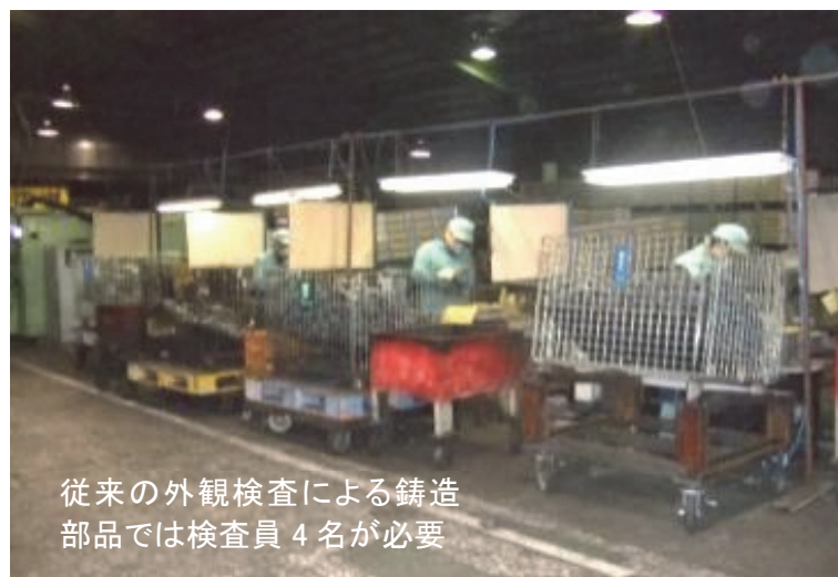
図 1.1 現在の目視検査状況
