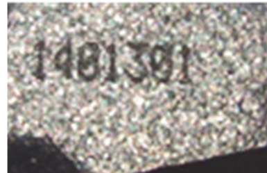
図 2.2.2 黒皮表面の刻印事例
