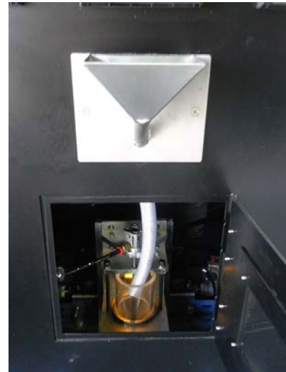
写真 2. 研削材投入口部
