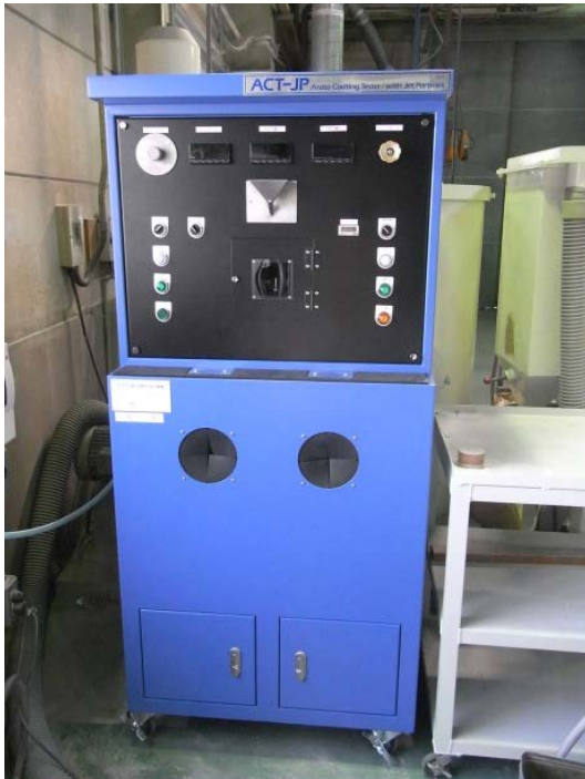
写真 1. ブラストエロージョン試験機(全体)
