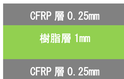
図 2-5 ターゲット材料 (CFRP 樹脂積層材)
