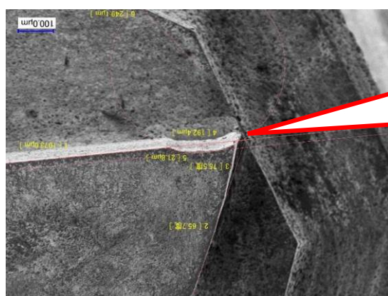
図11 レーザ照射条件の最適化により鋭利化した PCD 工具の刃先
