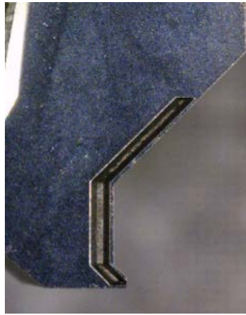
図26 開発した CFRP 樹脂積層材用 PCD 工具
