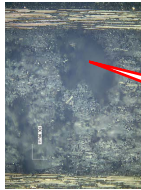
図29 チップブレイカ無しの樹脂層切削面
