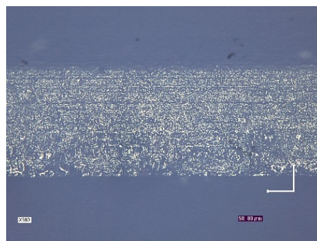
図21 傾斜溝無しの高硬度樹脂と軟質樹脂の積層材切削面
