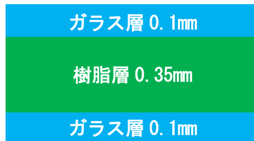
図13 ターゲット材料（ガラス樹脂積層材）
