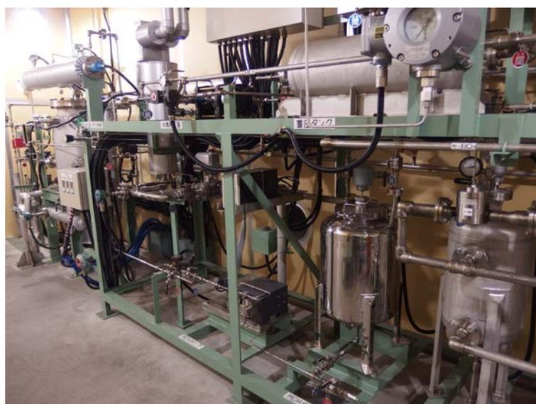
写真1 脱水素反応モジュール外観
