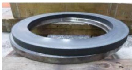
図 33 直径 420mm リング成形品（上）
