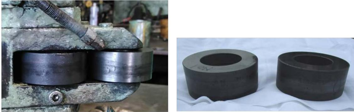
図 39 実証試験 2 回目の試作品（左）取付状態、（右）検査時
