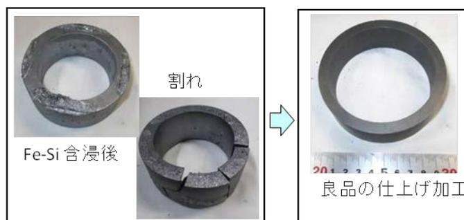
図 31  $\Phi 100$ リングの試作
