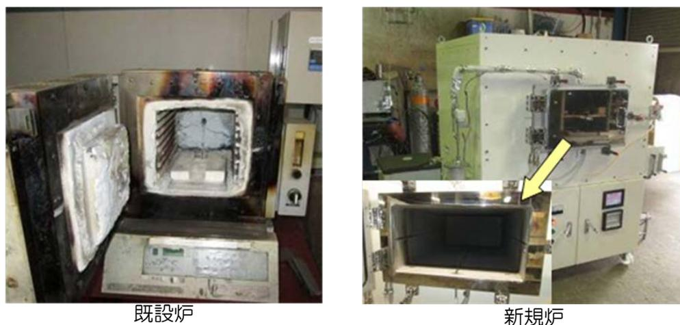
図10 炭化処理に用いる電気炉
