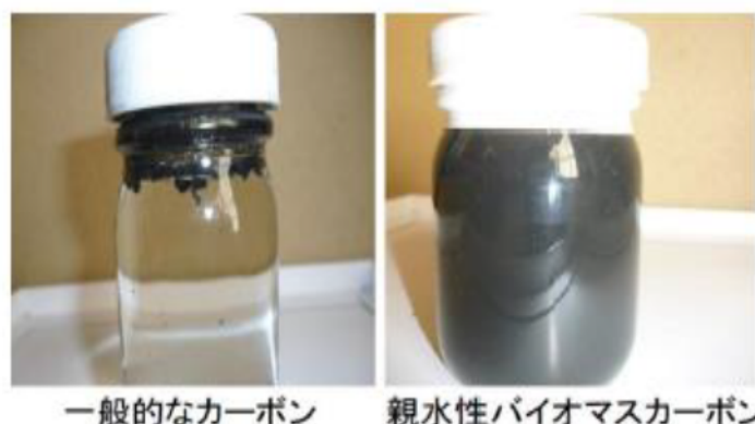
図2 5. 液中プラズマにより製造した親水性カーボンブラック
