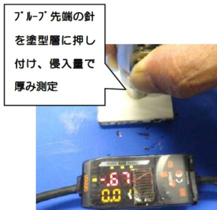
図 2.2.1 高精度塗型膜厚計
