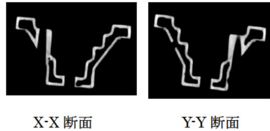
図 2.3.8 脱炭中空金型の X 線スキャナ画像
