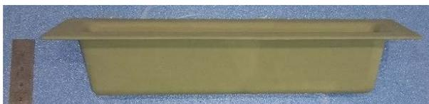
図 2.3.13 2mm 厚みの砂積層コーティング
