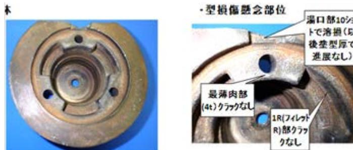
図 2.3.4 525 ショット後の金型表面損傷状況
