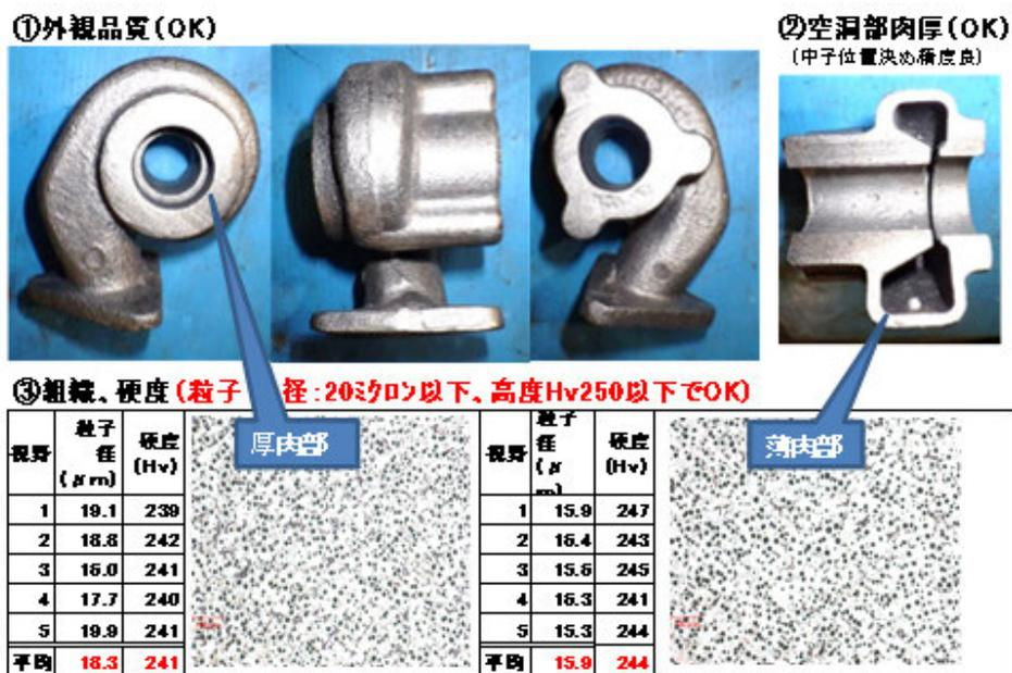
図 2.3.19 ターボハウジング試作品の品質確認結果
