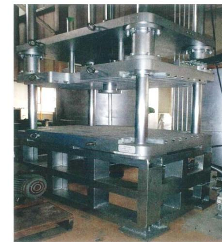
図 2.2.3 コンパクト金型鑄造機
