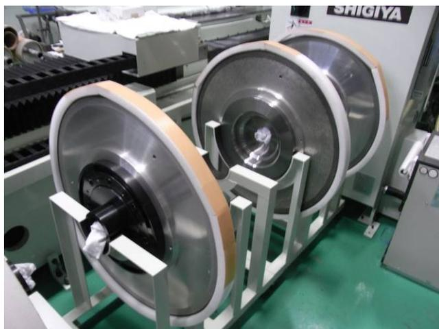
写真 2. ダイヤモンド砥石の外観写真
