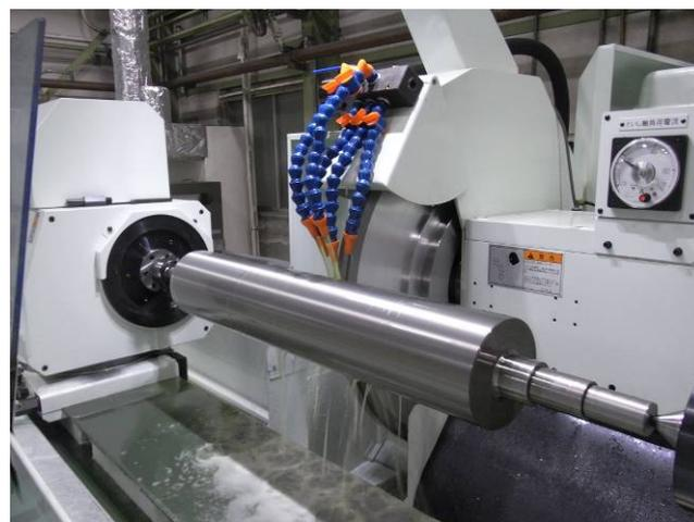
写真 3. 円筒研削加工時の様子
