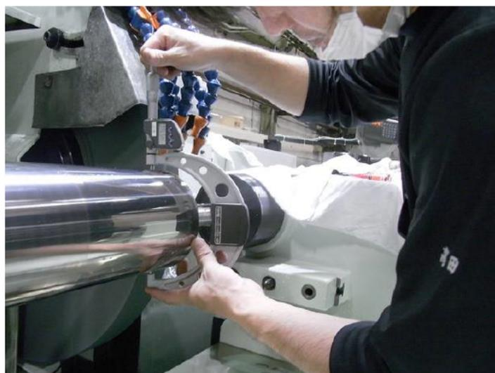
写真 5. 円筒度測定の様子(マイクロゲージにて)
