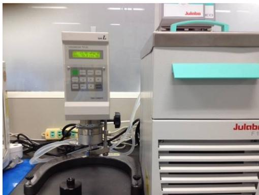
【写真 1 TVE-25 形粘度計の外観写真】
