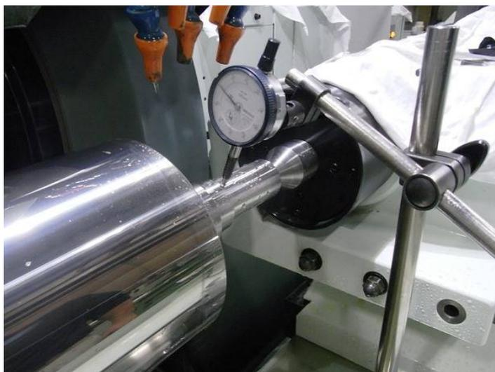
写真 6. 同心度測定の様子(ダイヤルゲージにて)
