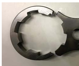
図 20 破損した反力受け(第 2 試作)
