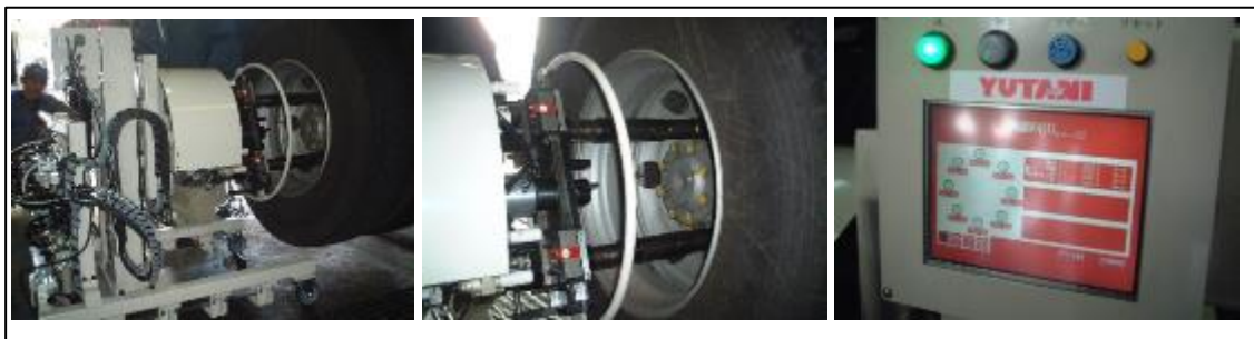
図 6 大型車両の車輪脱落防止締付機械試作機
