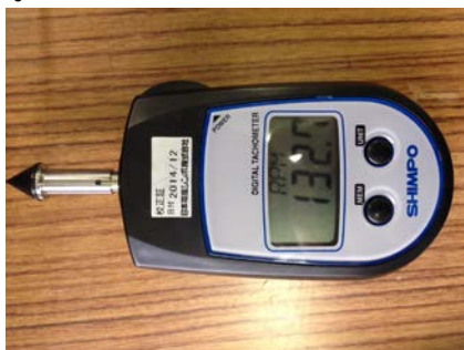
図 11 回転計(EE-1B/日本電産シンポ)
