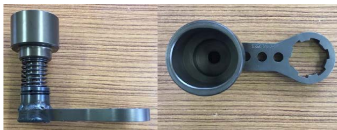
図 21 外付け反力受け 第 4 試作
