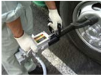
図 15 既存の1軸締付機械での作業風景
