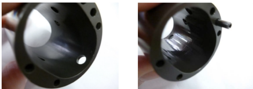
図 29 楕円形状シリンダ 左:耐久試験前 右:耐久試験 50000 サイクル後
