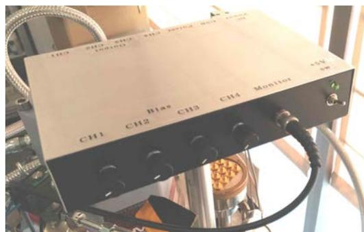
図 8. 開発したプリアンプコントローラー
