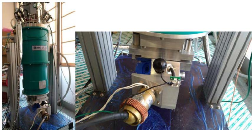
図 14. 簡易評価装置を組み込んだ超伝導検出器。左図；全体。右図：測定部拡大
