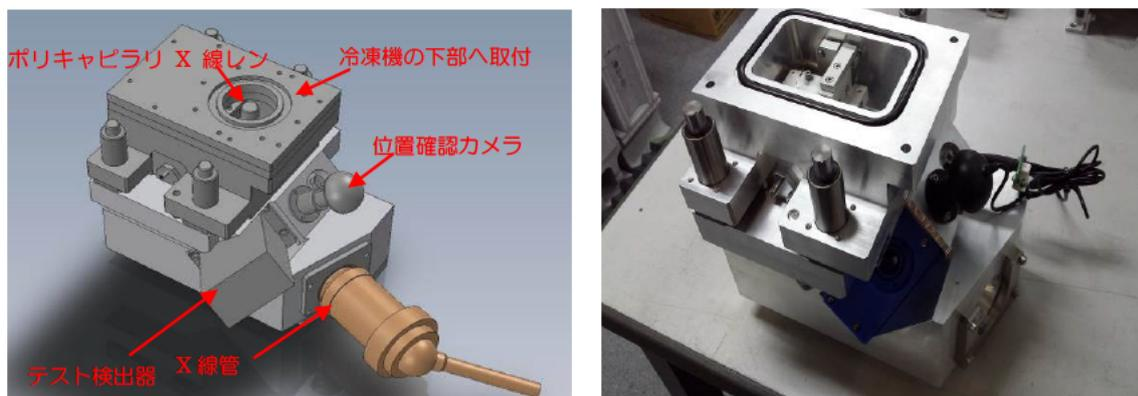
図 13. 簡易評価装置の 3D 図面と写真
