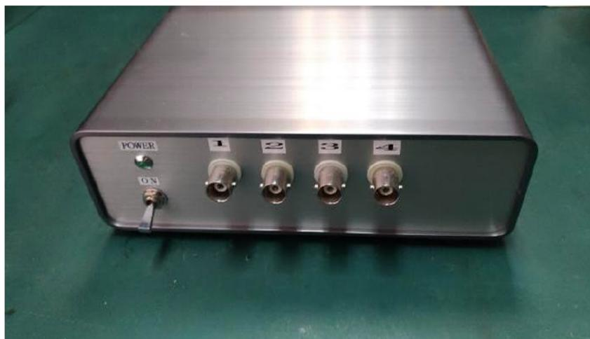
図10. TRAVIATAモジュールを組み込んだ信号処理ユニット
