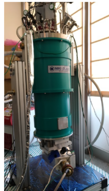
右図：開発した超伝導直列接合検出器(上部冷却器内部に検出素子他)と同蛍光X線簡易評価装置(下部)
