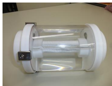
図2-1-2 改良後のスクリーニング細胞用大量培養ベッセル
