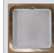
湿式電気化学めっき法による射出成形金型駒へのZrO<sub>2</sub>めっき
