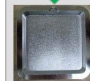
ZrO<sub>2</sub>めっき膜上に無電解めっき工法によるNi-Pめっきを構成
