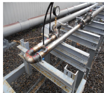
写真左：一体品複雑状削り出しダクト 写真中：ロケットエンジンダクト 写真右：流圧差測定実験装置 (流圧差・振動・加速度測定)
