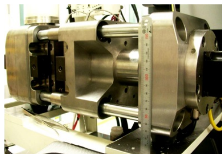
写真 4. 高さ 18 cm 超小型成形機
