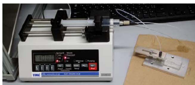
写真 8. バイオセンサーチップ用液送システム 接続時の様子
