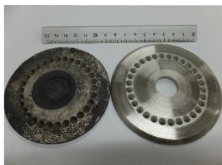
金属台座一体製法 型枠と試作品
