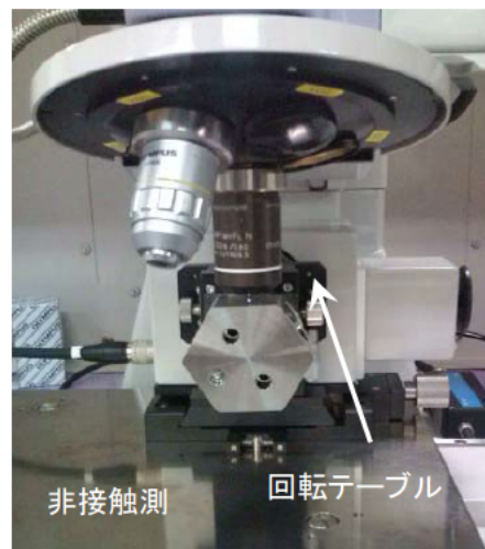
図 15 形状計測 (非接触測定器+回転テーブル)
