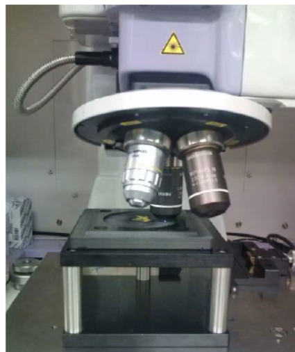
図 30 平面度および表面粗さ測定の様子
