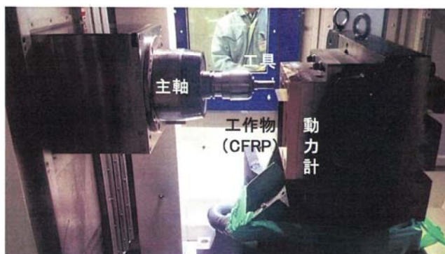
図 26 CFRP 切削（外周）の様子
