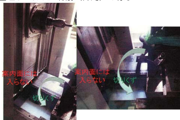
図 28 CFRP の切りくずの排出状態
