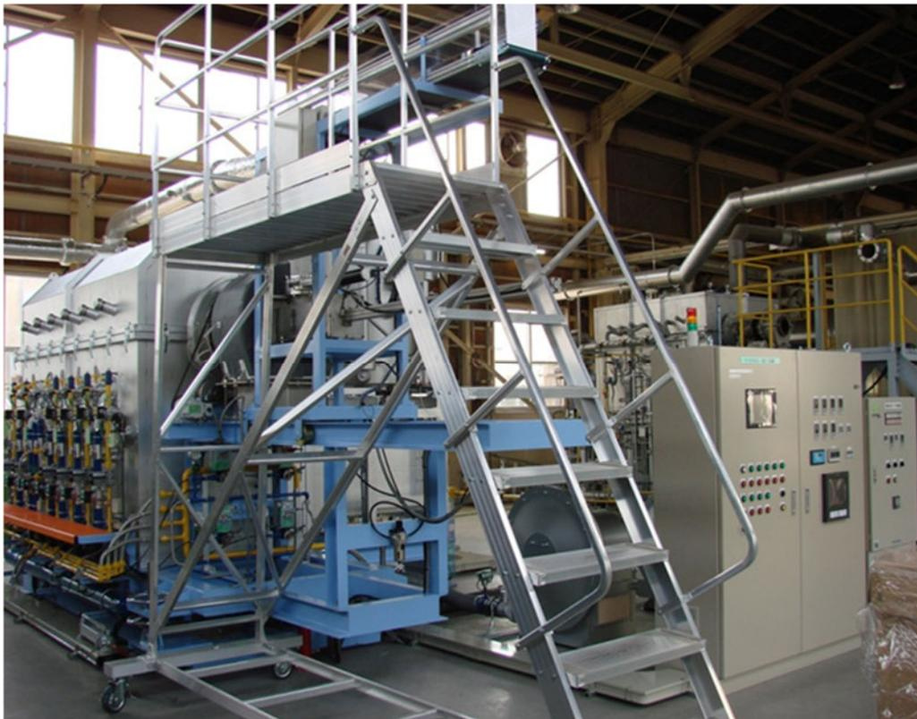
図4 開発ロータリーキルン装置の外観
